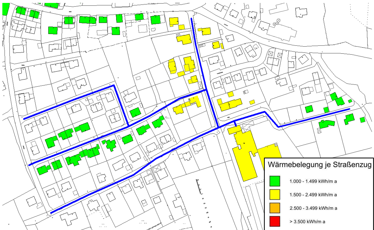
Abbildung 39: Trassenverlauf der Nahwärmeverbundlösung in Altomünster
